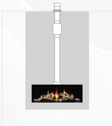
Système d'évacuation forcée en ligne avec longueur d'évacuation verticale
