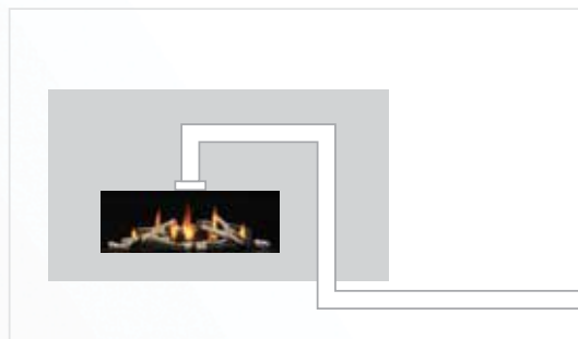
Évacuation forcée horizontale affleurante fin de ligne avec longueur de conduit négative
